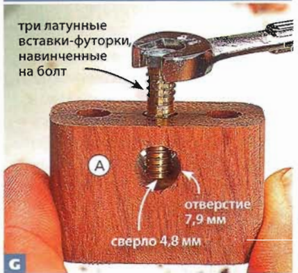
G Накладной головкой или гаечным ключом вверните болт М4 с накрученной вставкой-футоркой в дно 4,8-миллиметрового отверстия в головке А.
