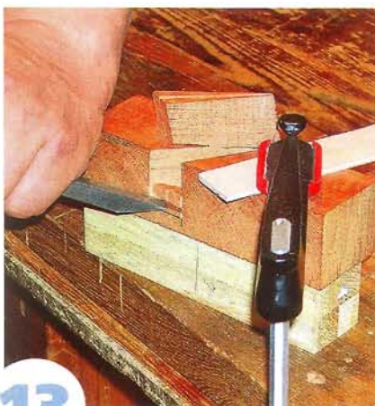
10 По разметке вручную мелкозубой (13-14 зубьев на дюйм) пилой-ножовкой делают глухие пропилы на глубину 34 мм (ширину железки). Применение такой пилы обеспечивает достаточную чистоту поверхности пропила. Вертикальное положение полотна ножовки обеспечивает вертикальную плоскость вспомогательного бруска (направляющей).
