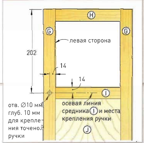
РИС. 3В. РАСПОЛОЖЕНИЕ ДВЕРНОЙ РУЧКИ (ВИД СПЕРЕДИ)
