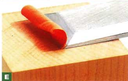
Е Плоская фаска и плоская тыльная сторона образуют острую режущую кромку, способную снимать тончайшие стружки даже на торце дерева.
