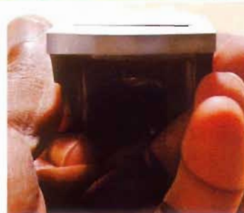
Это лезвие установлено несколько глубже, чем требуется, и должно быть слегка повернуто, так как его правый край заметно выше левого.
