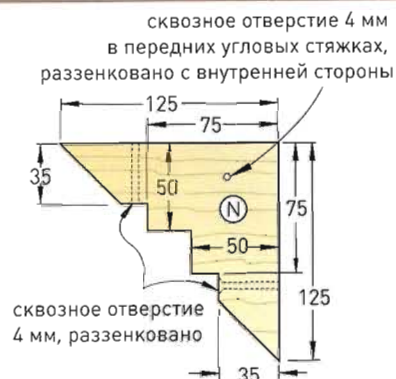
РИС. 5В. УГЛОВАЯ СТЯЖКА
