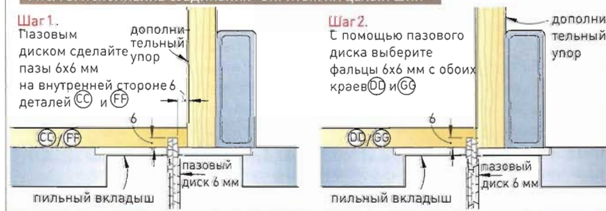
РИС. 7В. ИСПОЛНЕНИЕ СОЕДИНЕНИЯ «ВПРЫТЫК НА ЦЕЛЫЙ ШИП»
