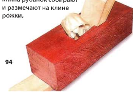
25 Собирают рубанок «Мышонок», пробуют в деле и производят окончательную доводку.
