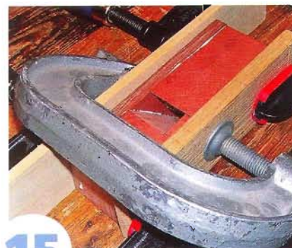
12 Посередине между двумя пропилами производят технологический пропил, который облегчит выдалбливание части летка.
