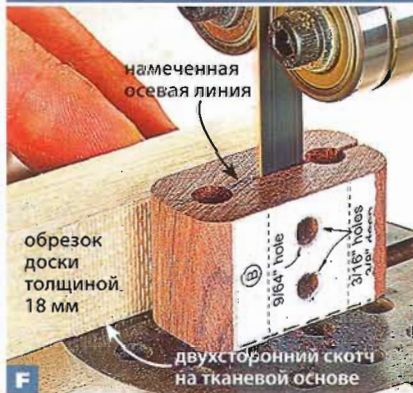
F Для безопасности приклейте осевую деталь к 18-миллиметровому обрезку двухсторонним скотчем. Затем распилите деталь пополам по намеченной осевой линии.
