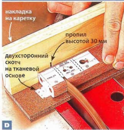
D Совместив пропил, обозначенный на чертеже, с пропилом на накладке, отрежьте детали С и В, а потом – деталь А.
