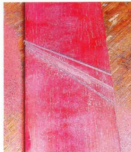
12 Посередине между двумя пропилами производят технологический пропил, который облегчит выдалбливание части летка.
