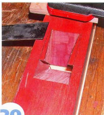
17 На подошве колодки проводят линию, ограничивающую глубину пропила.
