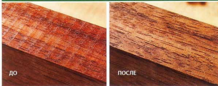
Внимательный осмотр кромки, остроганной на строгальном станке (слева), обнаруживает мелкие выступы и впадины, которые ослабляют склейку. Несколько легких движений ручным рубанком с остро заточенным лезвием удаляя неровности и сделают поверхность идеально гладкой (справа).
