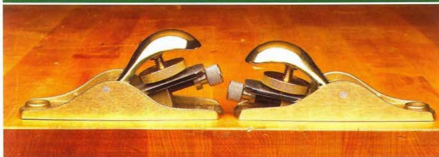
Эти два малых рубанка фирмы Lie-Nielsen практически одинаковы во всем, кроме угла установки лезвия. Слева – рубанок-оборотник 103 со стандартным углом, справа – торцевой рубанок 102 с малым углом наклона железки.
