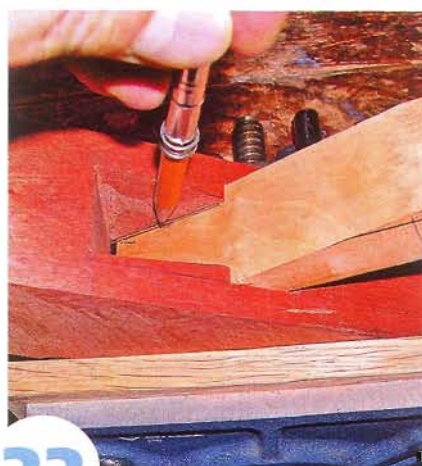
19 Колодку зажимают в тисках и выдалбливают переднюю часть лотка.
