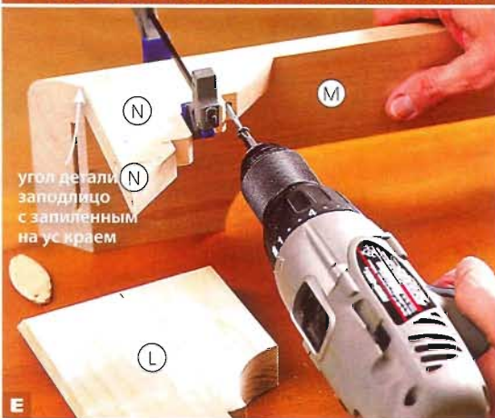
Используя отверстия в угловых стяжках N как направляющие, просверлите глухие отверстия в передней детали основания M и закрутите шурупы.
