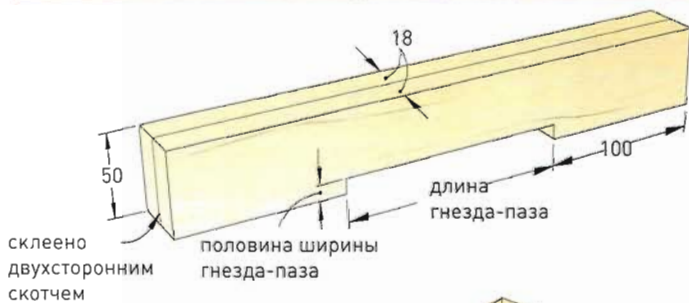
РИС. 2. ШАБЛОН ДЛЯ ФРЕЗЕРОВКИ ГНЕЗДА-ПАЗА С УПОРОМ
