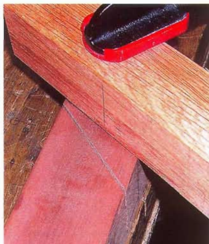
8 Это следующая операция: разметка летки на верхней плоскости заготовки с учетом ширины железки.
