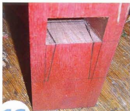
16 Размечают заплечики. Толщина их выступающей части должна составлять 5-6 мм.
