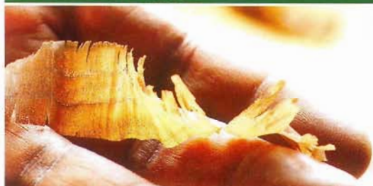
Строгая торцы, не пытайтесь снимать помногу. Толщина этой полупрозрачной ореховой стружки близка к оптимальной.
