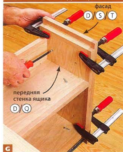
Зафиксируйте шурупами приклеенный двухсторонним скотчем фасад D/S/T к передней стенке ящика D/Q, чтобы предотвратить смещение. Затем с помощью шурупов стяните фасад и переднюю стенку ящика.
